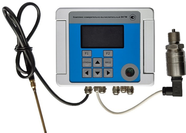
б) модификация ВКТМ.1 с выносным датчиком давления
