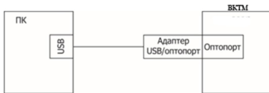
Схема подключения ВКТМ к ПК через оптопорт
