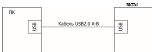
Схема подключения ВКТМ, расположенного во взрывобезопасной зоне, к ПК через порт USB
