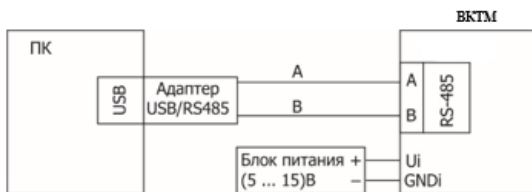
Схема подключения ВКТМ, расположенного во взрывобезопасной зоне, к ПК через порт RS-485
